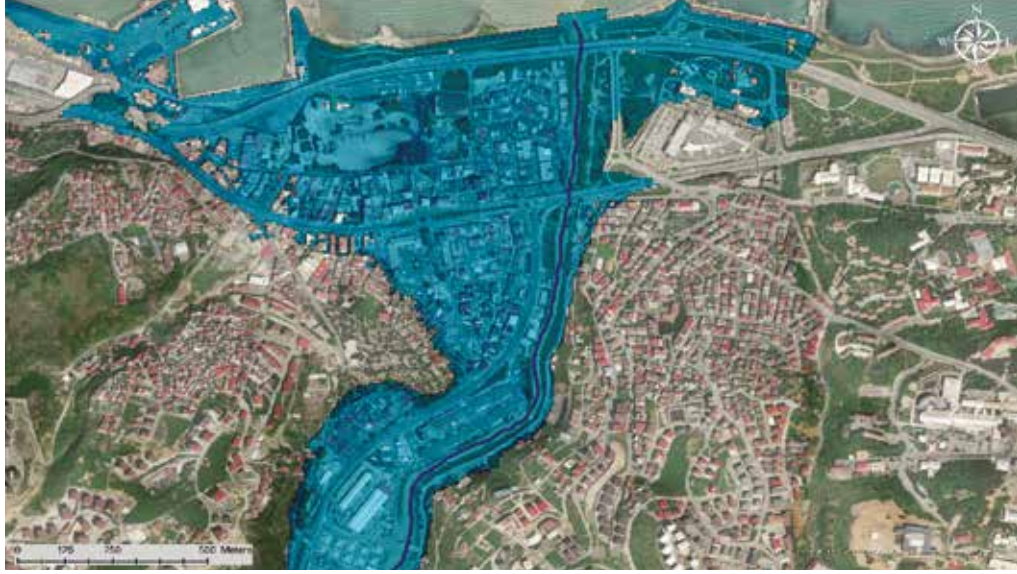
Atasu Barajının Patlaması Durumunda Meydana Gelebilecek Taşkın Yayılımı
